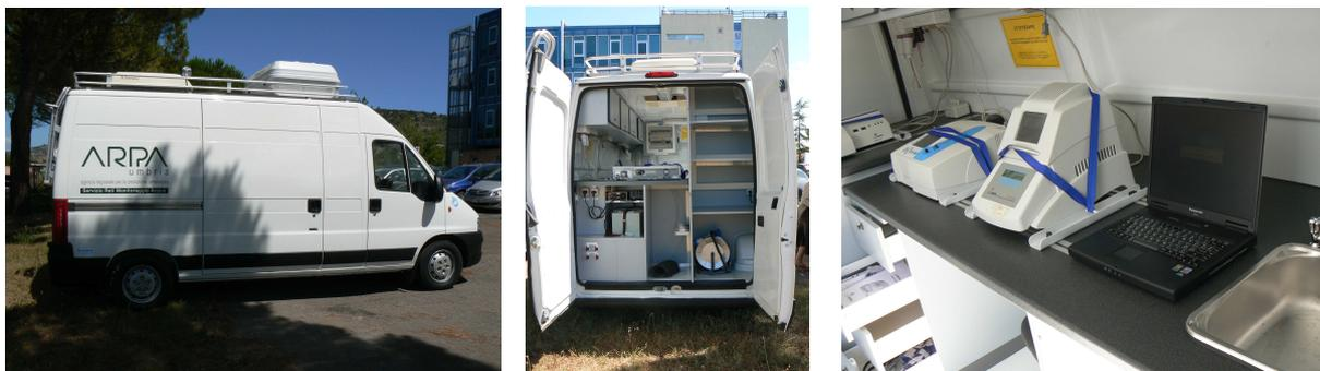
**Fig. 2.1** – Particolari del laboratorio mobile utilizzato dall’Agenzia per le determinazioni in campo.
